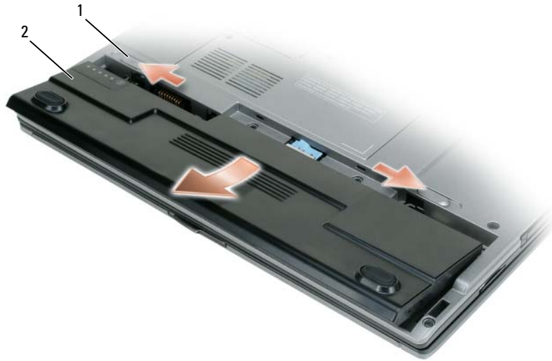
1 電池凹槽釋放門鎖 2 主電池
